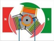
Das Bild zeigt einen Elektromotor im Querschnitt
